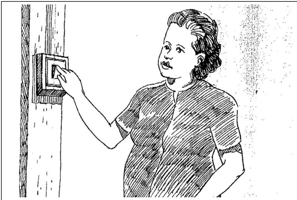
รูปที่ 7-1 ติดตั้งสวิตช์ ปุ่มควบคุม ให้อยู่ในระยะและระดับที่ควบคุมได้ง่าย
